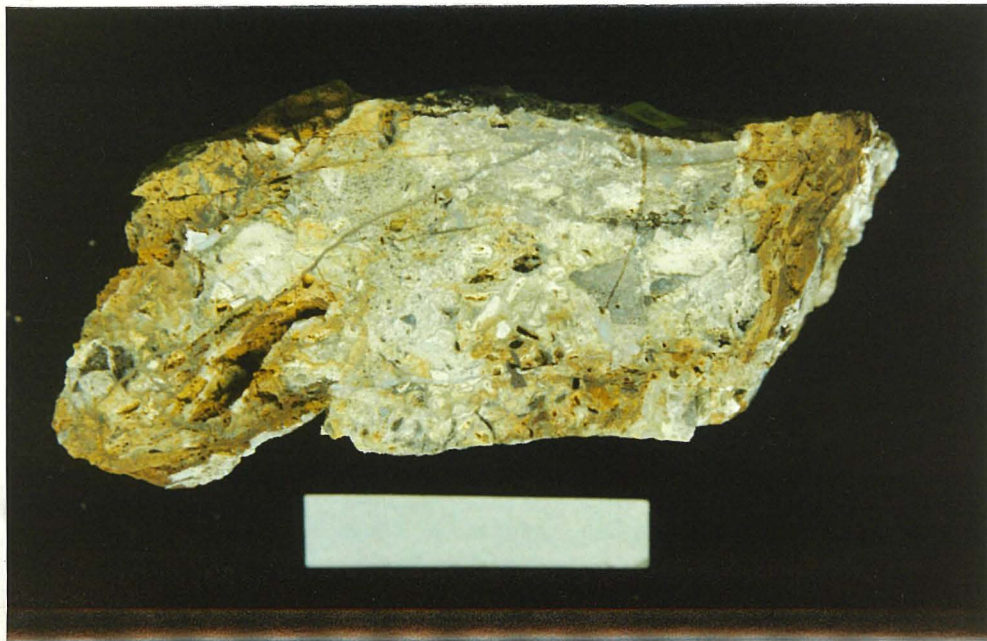
Abb. 3.6 Störungsbrecie mit Limonitvererzung aus einem Stollen W der Scharte. Die Komponenten sind teilweise durch Calcit miteinander verkittet. Limonit durchsetzt auch jüngere Frakturen (182). Maßstab: 5 cm.
