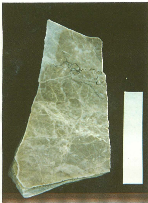
Abb. 4.11 Bituminöser, tektonisch Beanspruchter mudstone mit Lösungssutur. Die Risse sind spätdiagenetisch mit Calcit gefüllt. (121). Maßstab: 5 cm.
