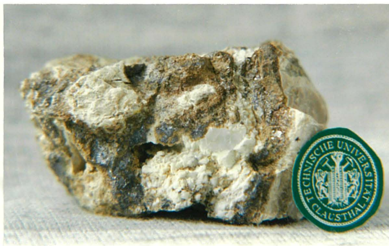
Abb. 3.1 Vererzte Breccie aus Wettersteinkalk. Die Zwischenräume der Komponenten sind durch Bleiglanz und Zinkblende ausgefüllt. Ein verbliebener Hohlraum enthält weiße, sattelförmige Dolomitekristalle sowie Calcit. Um die Zinkblende bilden sich braune Ränder aus Limonit sowie gelbe, erdige Anflüge von Greenockit (CdS). (Aus der Privatsammlung Verfassers, Probe Nr. 19088101). Maßstab: 1,5 cm.
