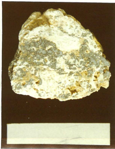
Abb. 3.17 Bleiglanz und Limonit in einer stark zerriebenen Störungsreccie aus Wettersteinkalk. Maßstab: 5 cm.
