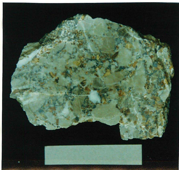
Abb. 3.20 Längs Korngrenzen vererzte Breccie aus Wettersteinkalk. Zinkblende: dunkelbraun bis gelb, Bleiglanz grau (238b). Maßstab: 5 cm.
