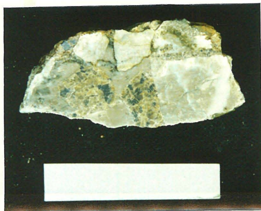
Abb. 3.2 Vererzte Breccie. Zu erkennen ist braune Zinkblende in einer feinkörnigen Karbonatmatrix sowie schwarzbrauner Limonit (Abb. 184c). Maßstab: 5 cm.
