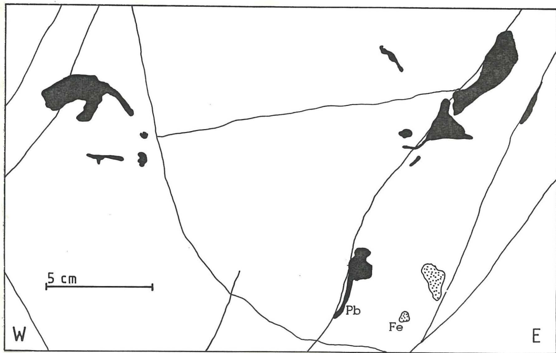
Abb. 3.11 Bleiglanz, an Störungen im dolomitisierten Wettersteinkalk gebunden (■133). Pb: Bleiglanz; Fe: Limonit.
